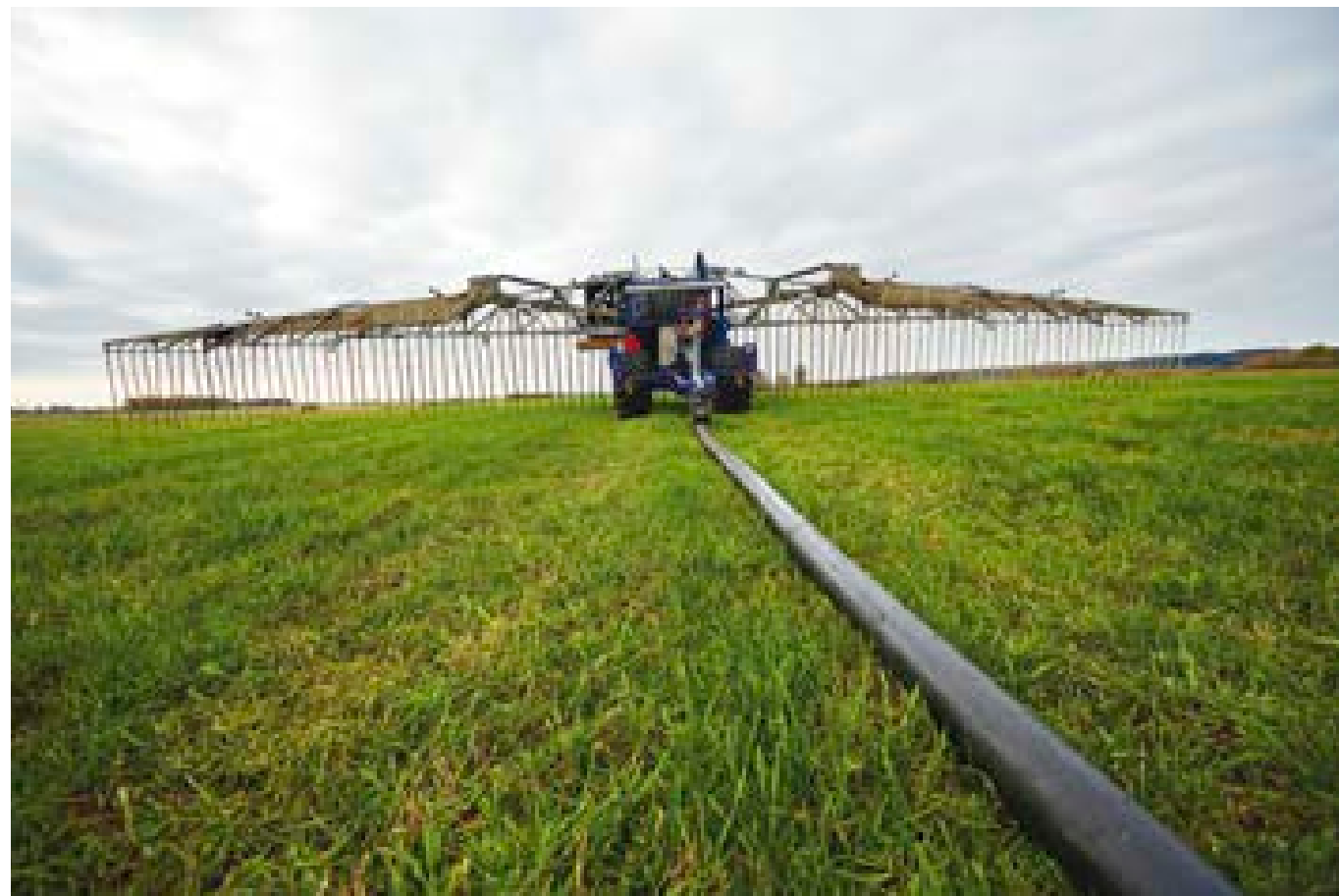
Genom att koppla samman gödselutläggaren och gödselbassängen med en kilometerlång slang slipper man frakta med sig all gödsel ut på åkern. Det gör arbetet effektivare och mindre påfrestande för åkermarken.
